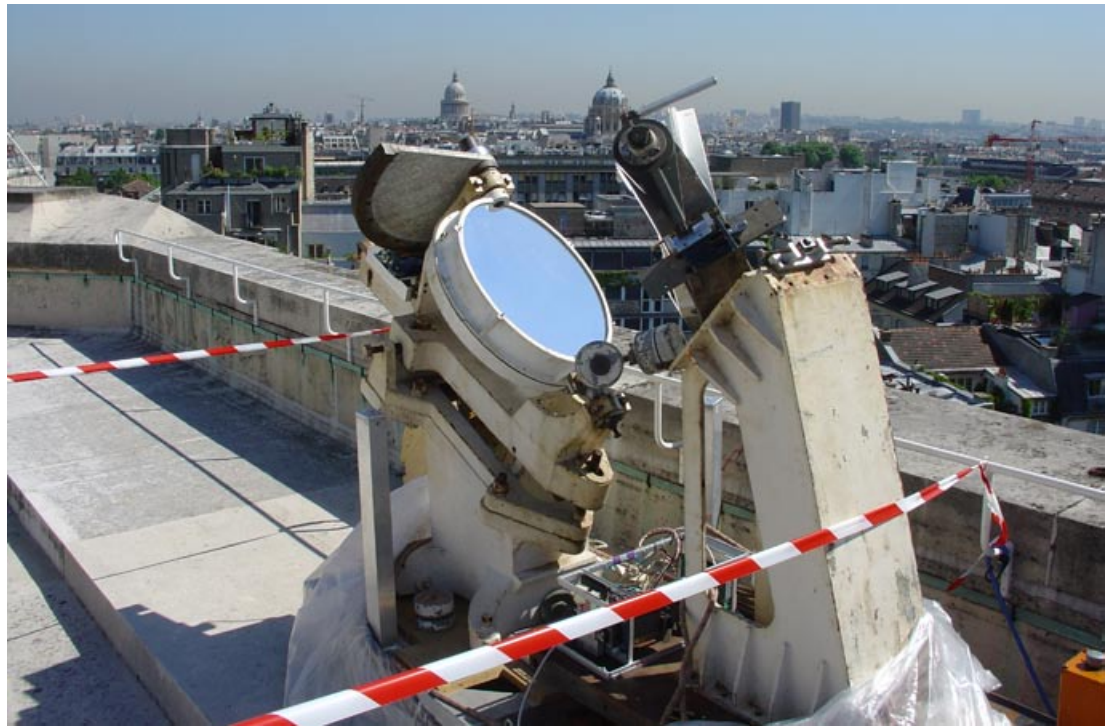
Le jeu de miroirs du cœlost permet de diriger le flux lumineux solaire vers les salles d'expérience
