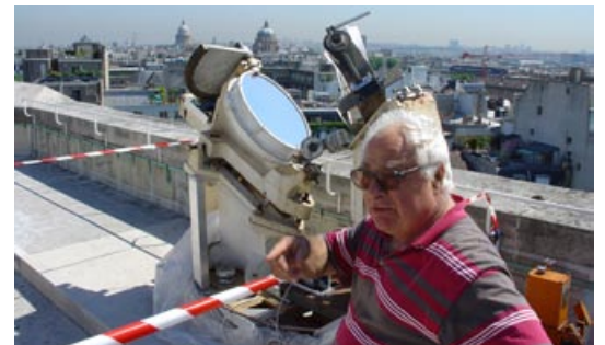
Coelostat lorsqu'il était installé sur le toit de l'Observatoire de Paris
